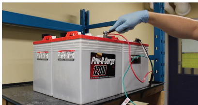
図2: バッテリーパックの正極から正のリード線を取り外します。
