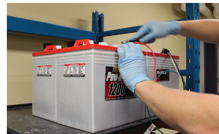
図8: AC電源の切断後、正のリード線を正極に再度取り付けます。
