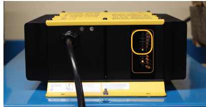
図5: 電流計上の充電プロファイル番号1。
